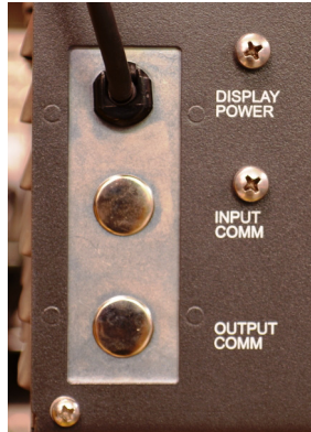
Rysunek 2-11 Połączenia zasilania i regulacji temperatury wyświetlacza
